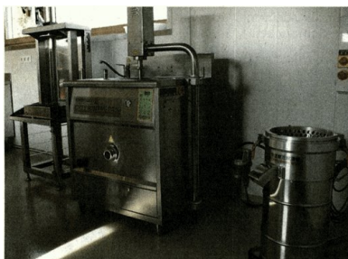
Ullas neue Tofulinie besteht aus Mühle samt Zentrifuge, Siedekessel und pneumatischer Presse. Die für Kleinbetriebe passende Einrichtung stammt von einem spezialisierten Hersteller in Taiwan.
